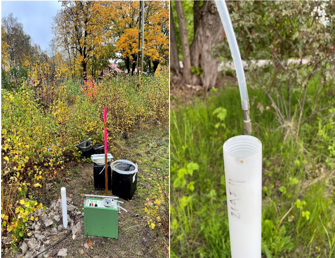
Figur 12. Grundvattenrör i provpunkt 21AF09. T.h. Skakpump för uttag av vattenprov för analys med avseende på klorerade lösningsmedel.
