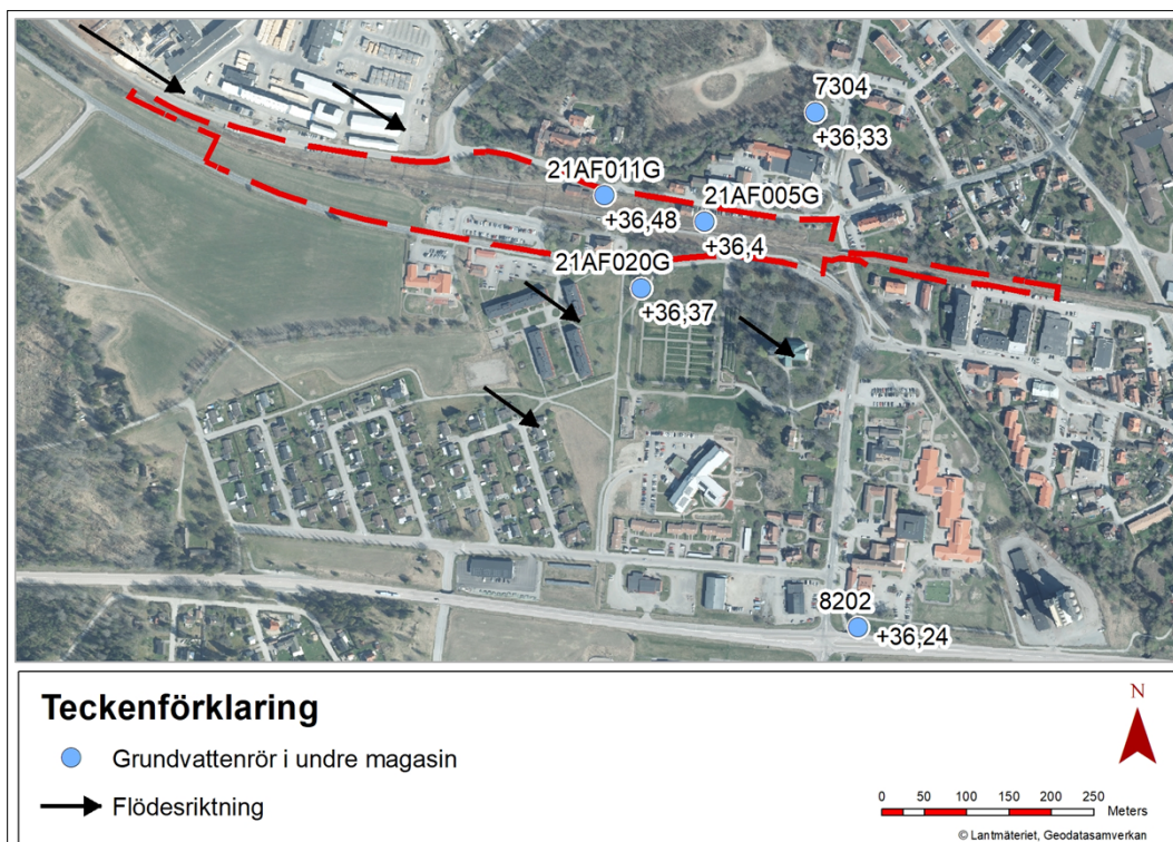
Figur 6. Karta över grundvattenrör med avslut i grundvattenmagasinet under leran samt i Enköpingsåsen tillsammans med uppmätt medelnivå under perioden oktober 2021-januari 2024. Pilar indikerar generell riktning på grundvattenströmningen i området.
