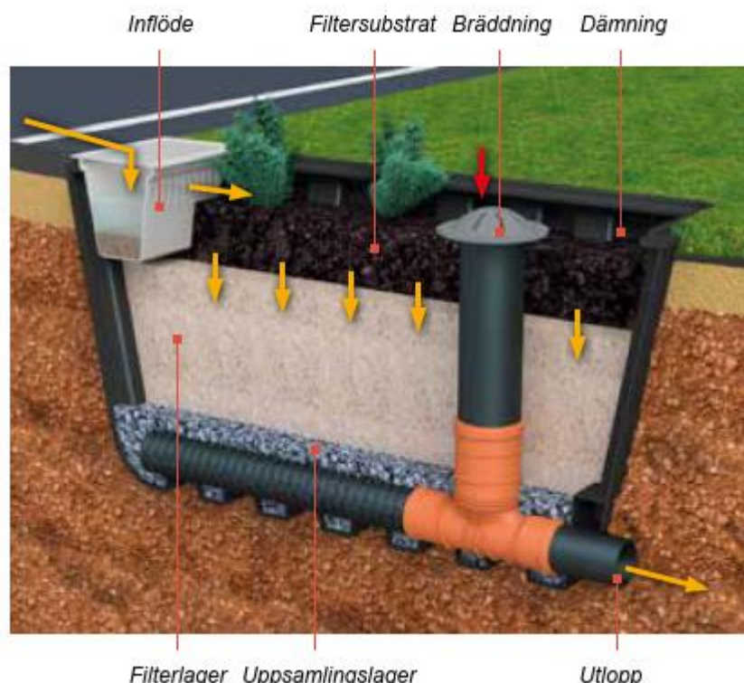
Figur 14 - Foto på anläggning av Uponor regnbädd samt förklarande illustration (Foto/Illustration: Uponor).
