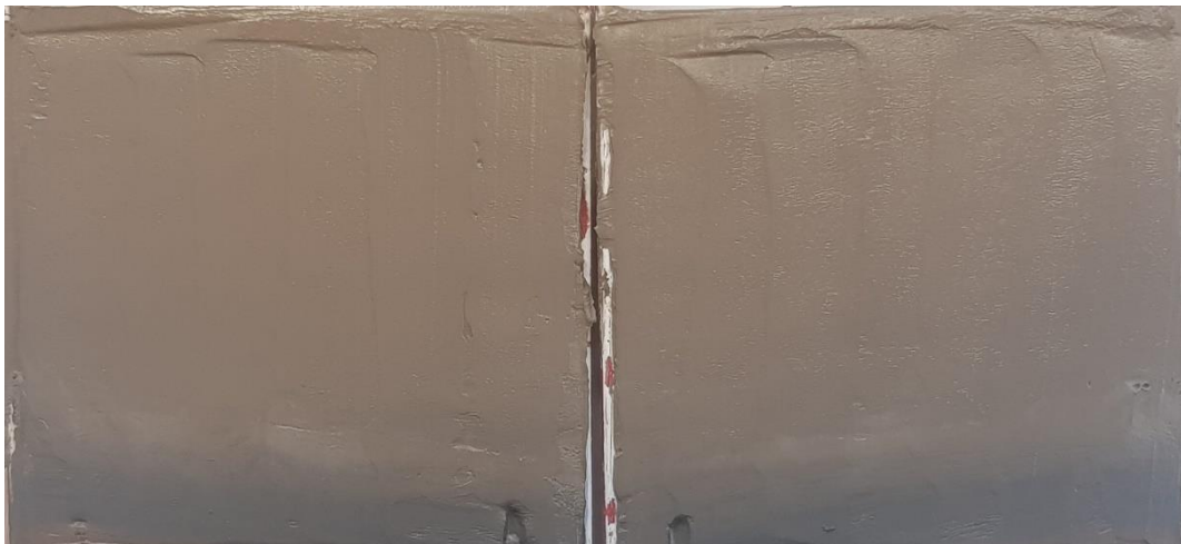
Figur 2 Borrpunkten, BG20001, 6,0 m, Jordprovet i nedre delen av mellanhylsan delad longitudinellt provhylsan med id Bjerking 653.
