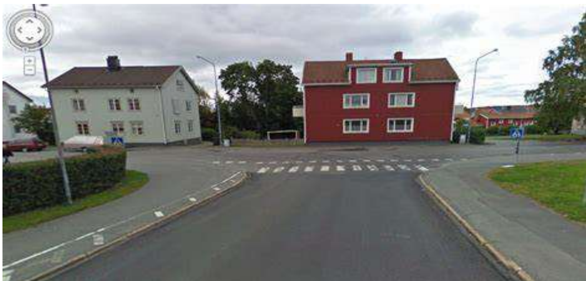
Figur 11. Bilden ovan visar hur man kan använda sig av vägmarkeringar. I detta fall är det även ett övergångsställe. Vid en cykelpassage räcker det med "sockerbitar". Foto: Instant streetview.
