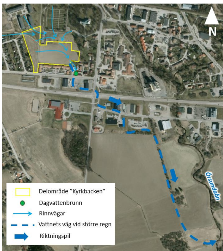
Figur 3. Avrinningsvägar för ytligt avrinnande vatten inom och runt "Kyrkbacken" samt vattnets väg mot recipient vid större regn. Analysen är gjord med hjälp av SCALGO Live och erhållen VA-underlag.
